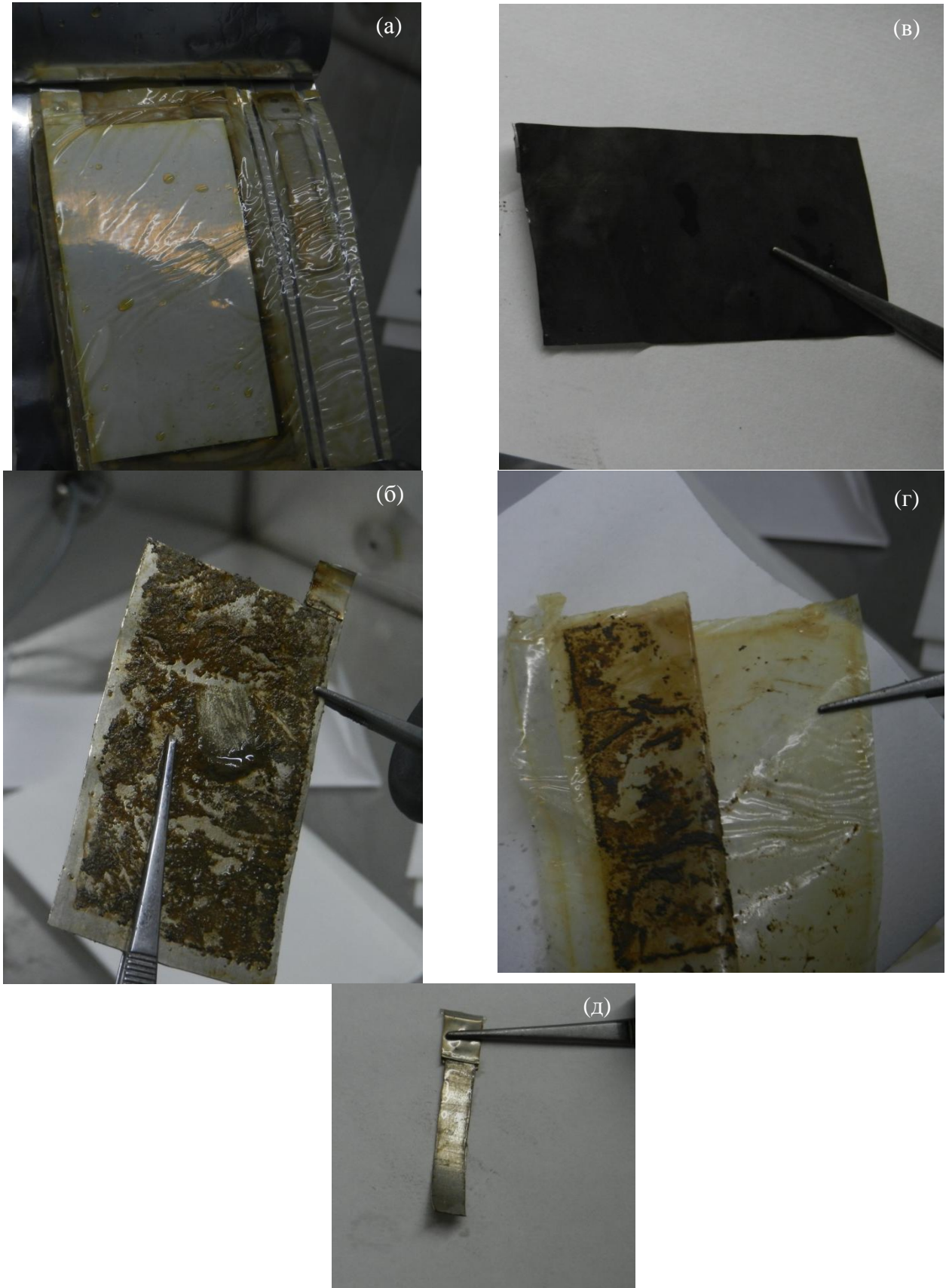
Рисунок 3.19 – Фотографии составных частей электрохимической ячейки после испытаний материала \text{Li}_{1,2}\text{Ni}_{0,2}\text{Mn}_{0,6}\text{O}_2 . Общий вид (а), литиевый противоэлектрод (б), положительный электрод (в), сепаратор (г) и литиевый электрод сравнения (д)
