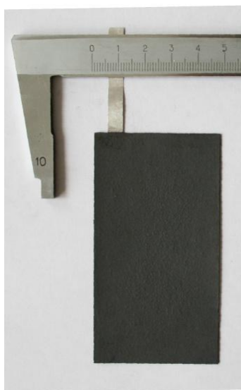
Рисунок 2.3 – Внешний вид электрода, изготовленного по технологии ПАО «Сатурн»
