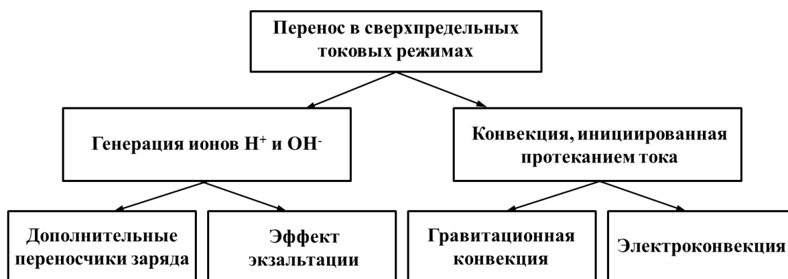
Рисунок 1 – Механизмы переноса в сверхпредельных токовых режимах
