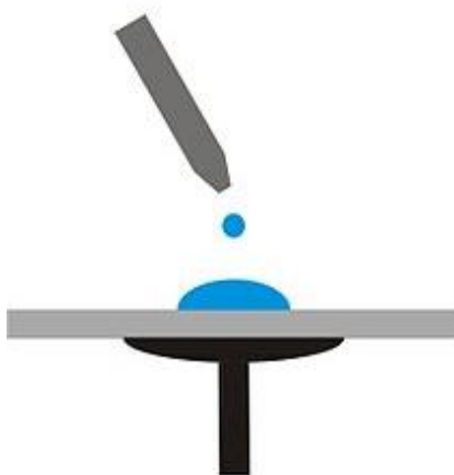
Рисунок 4 – Нанесение покрывающей жидкости на твердую подложку
