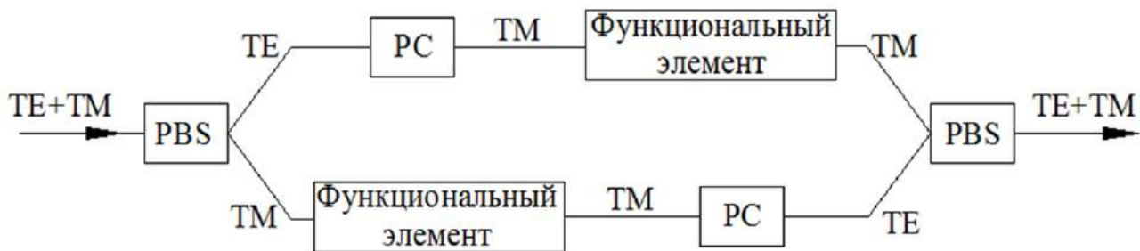
Рисунок 1.4 – Схема поляризационно-разнесенной обработки оптических сигналов
