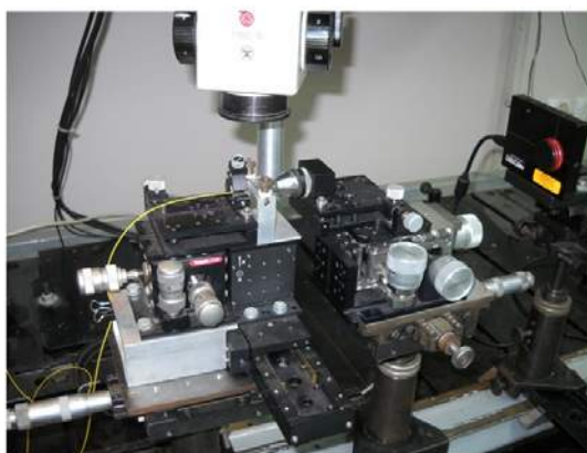
Рисунок 3.48 - Фотография базовой части станда для проведения измерений интегрально-оптических элементов и схем
