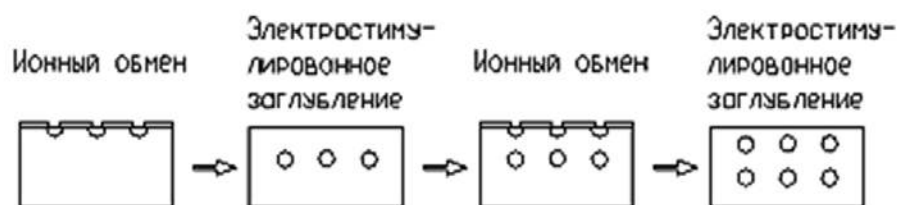
Рисунок 3.16 – Схема методики формирования двухслойных интегрально-оптических схем путем многоэтапного ионного обмена и электростимулированной миграции ионов
