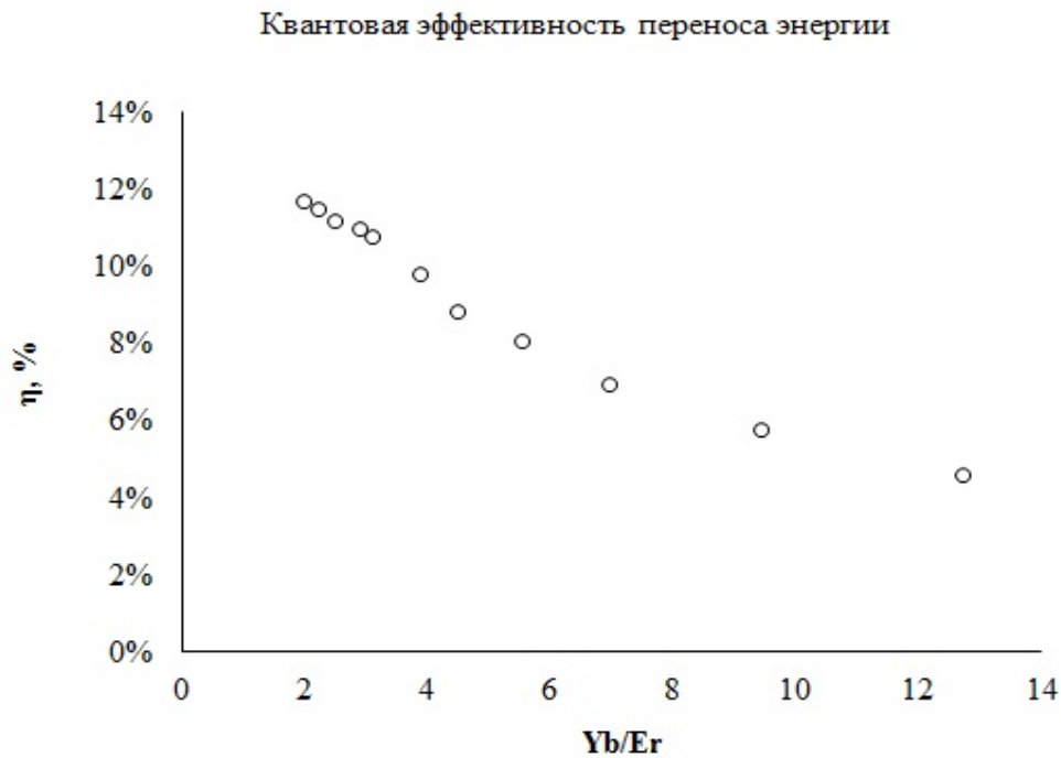
Рисунок 59 – Зависимость квантовой эффективности переноса энергии электронного возбуждения от отношения концентраций доноров к акцепторам (рассчитана для кинетик затухания на длине волны 1030 нм)
