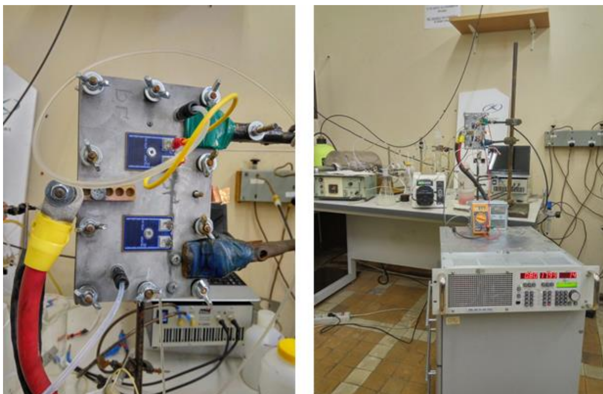
Рис. 6.17 – Фотографии лабораторного образца испытательной ячейки с рабочей площадью 50 см 2 для процесса электровосстановления бромат-аниона
