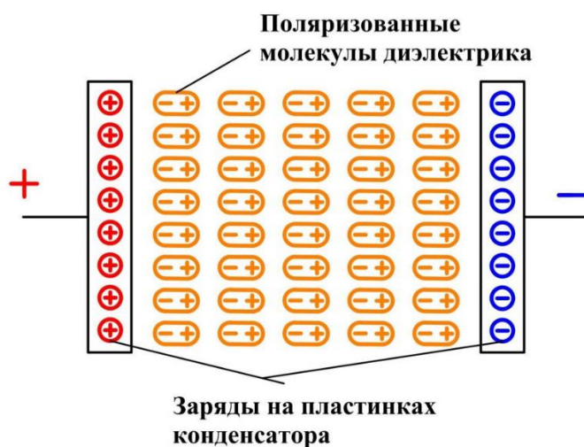
Рис. 1.1 – Принцип работы конденсатора
