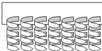
Рисунок 2.6. – Схематическое изображение геометрической формы электродов в ячейке для измерения электроосмотической проницаемости
