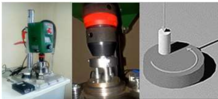
Рисунок 54 – Установка для трибологических испытаний: (слева) универсальная машина трения УМТ-200; (посередине) узел трения установки; (справа) геометрическая конфигурация для трибо-тестирования
