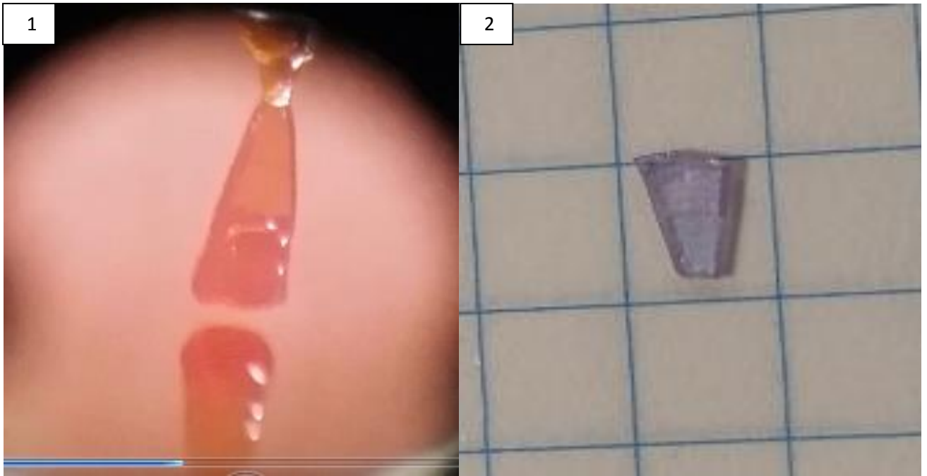
Рисунок 4.7г – Фото монокристалла \text{Nd}^{3+} : ВВиМ образовался при условии: градиент температуры 11\text{ }^{\circ}\text{C}/\text{см} и скорость вытягивания 0,3\text{ мм}/\text{час} .
