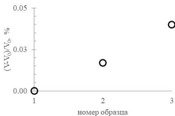
Рисунок 3.3 – Изменение объема элементарной ячейки для образцов, вырезанных из различных частей градиентного кристалла
