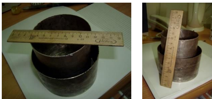
Рисунок 2.26 – Общий вид внешнего и внутреннего Pt-тиглей увеличенного диаметра ростового узла
