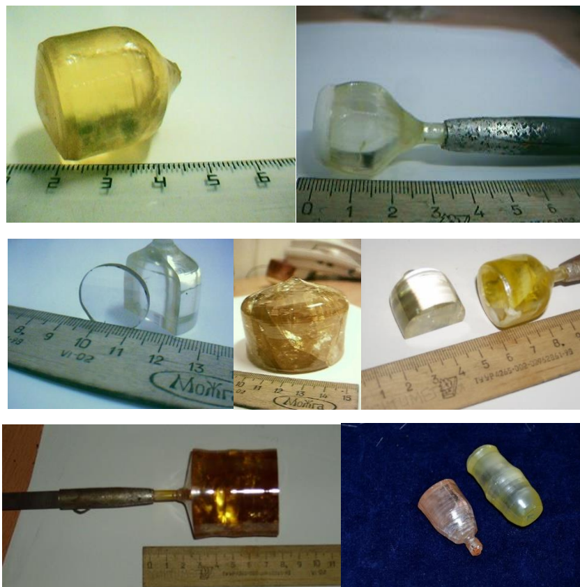
Рисунок 2.10 – Примеры выращенных кристаллов ниобата лития при реализации предложенной и реализованной системы автоматического управления диаметром кристалла
