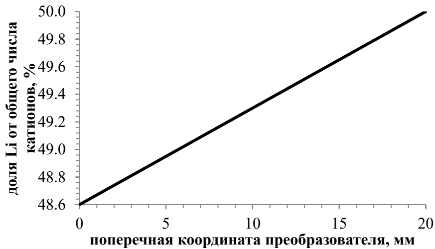
Рисунок 4.6 – Распределение концентрации Li + в PPLN по поперечной координате (линейный профиль) [203]
