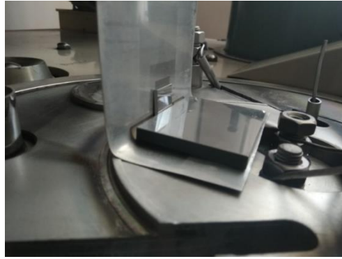
Рисунок 5.35 – Образец после напыления слоя алюминия
