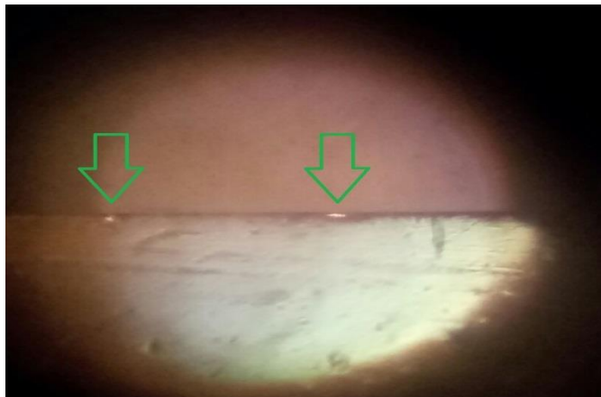
Рисунок 5.42 – Вид полученных волноводов в градиентной пластине ниобата лития
