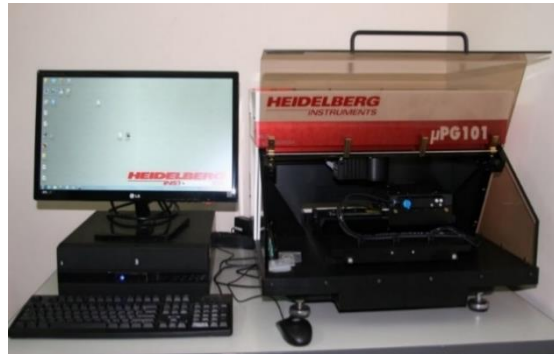
Рисунок 4.15 – Используемый для формирования PPLN комплекс лазерной безмасковой литографии «μPG101»
