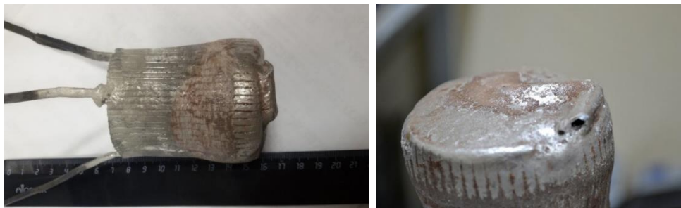
Рисунок 2.16 – Вид рифленной поверхности внутреннего Pt-тигля
