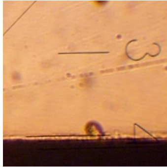
Рисунок 5.38 – Внешний вид планарного волновода, сформированного в градиентном ниобате лития после травления в бензойной кислоте в течение 1 часа 45 минут
