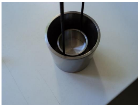
Рисунок 2.21 – Фото системы двух молибденовых тиглей для реализации жидкостной подпитки
