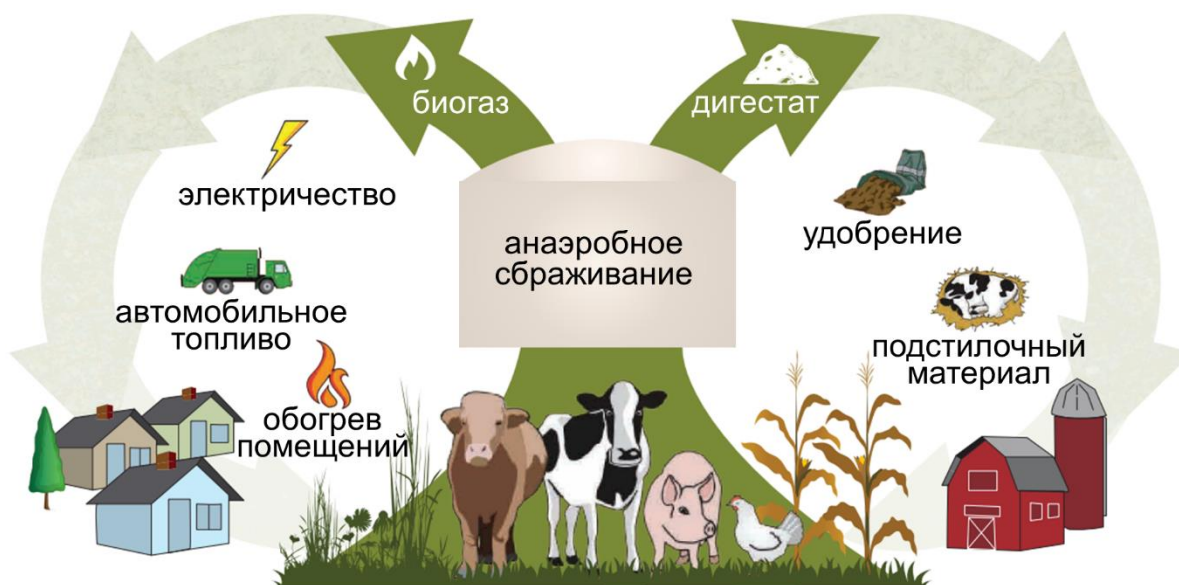
Рисунок 3 – Схема применения продуктов анаэробного сбраживания навоза сельскохозяйственных животных
