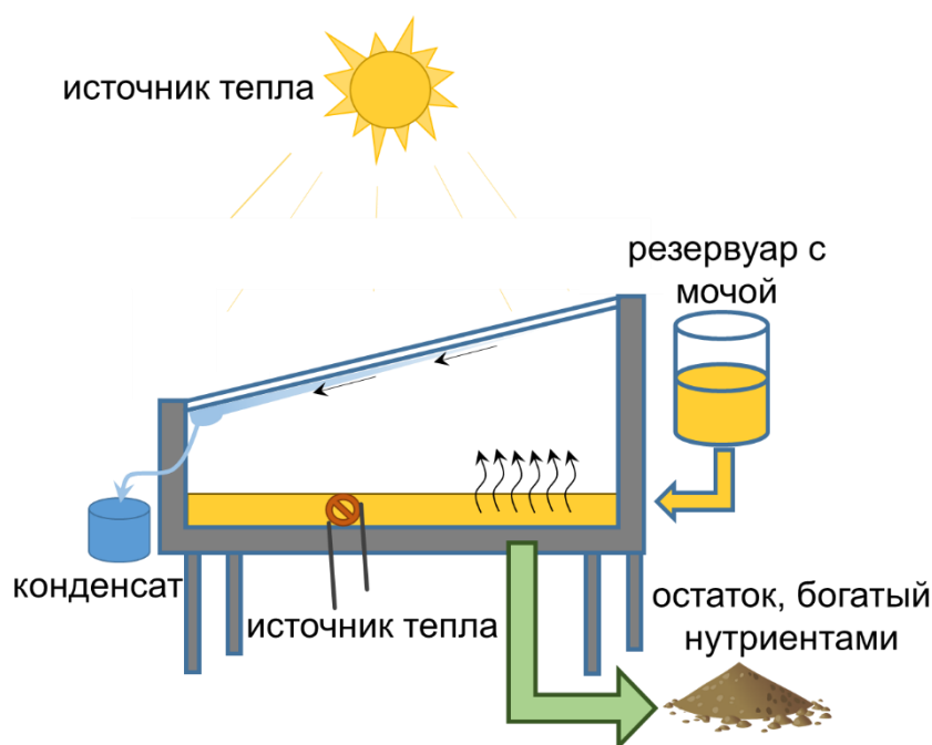
Рисунок 4 – Схема осуществления выпаривания воды из мочи
