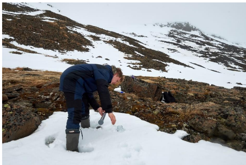
Рисунок 6 – Процедура отбора пробы снега.
