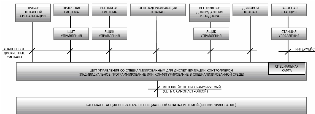
Рис. 3. Структура системы автоматизации и диспетчеризации здания
