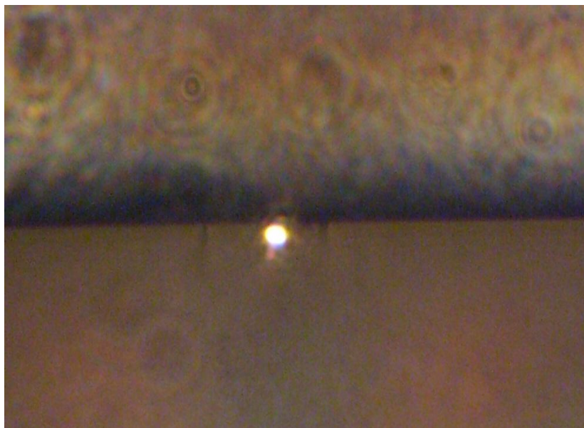
Рисунок 2 – Внешний вид торца интегрально-оптического заглобленного волновода
