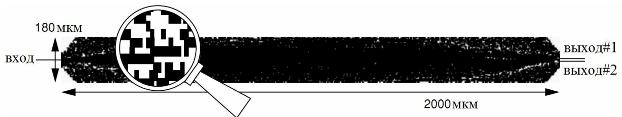
Рис. 4. Разработанный шаблон разветвителя [2]
