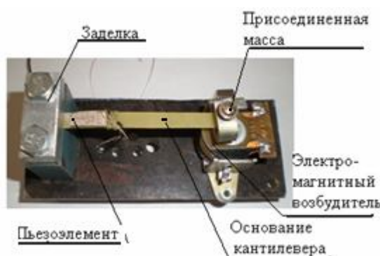
Рис.2 . Пьезогенератор кантилеверного типа с присоединенной массой и электромагнитным возбуждением. Биморф выполнен из пьезокерамики ЦТС-19, размером 15x7x0.5 мм.
