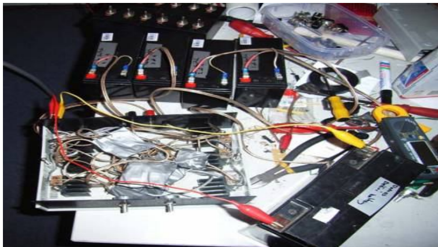
Рисунок 5. Система импульсного заряда для использования в системах резервного электроснабжения
