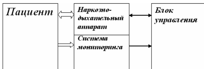
Рисунок 1. Блок схема наркозно-дыхательной установки
