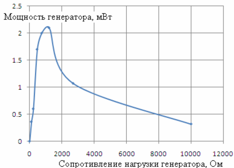
Рис.7. Зависимость выходной мощности многослойного пьезогенератора от величины нагрузки
