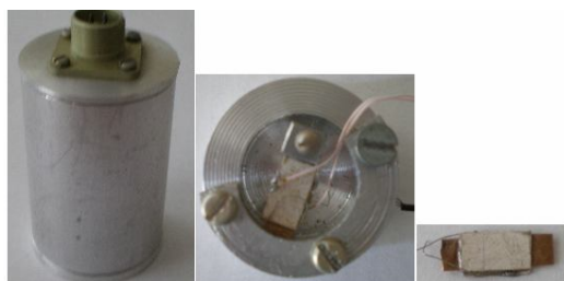
Рис.1. Пьезогенератор кантилеверного типа, работающий на изгибных колебаниях: слева–модуль кантилевера в сборе, в центре–вид со снятой крышкой корпуса, справа – пьезоэлемент ПГ.
