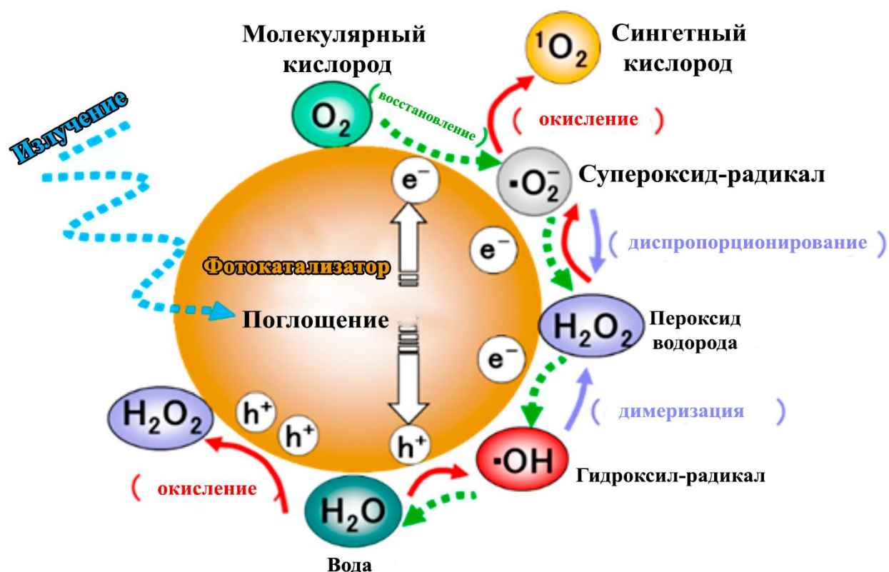
Рисунок 1.6. Схема генерации активных форм кислорода при фотокатализе: восстановительный путь ( O_2 ) и окислительный путь ( H_2O ) [81]
