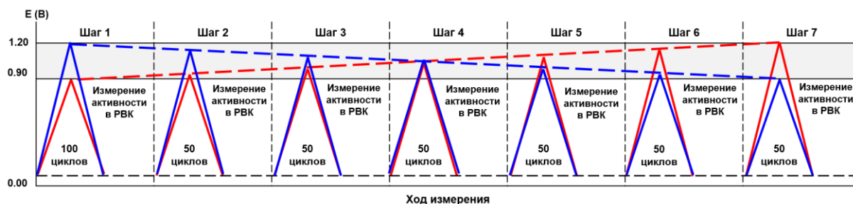
Рисунок 2.7 – Последовательная схема выполнения электрохимических измерений в условиях ступенчатого изменения UPL. Каждый шаг включал 100 или 50 циклов активации катализатора в диапазоне 0.04 В – UPL в атмосфере Ar и последующую регистрацию вольтамперограмм при 4-х скоростях вращения ВДЭ в атмосфере O 2 . На каждой следующей ступени значение UPL увеличивали на 0.05 В (красные линии), уменьшали на 0.05 В (синие линии) или поддерживали постоянным UPL = 0.90 В [224]
