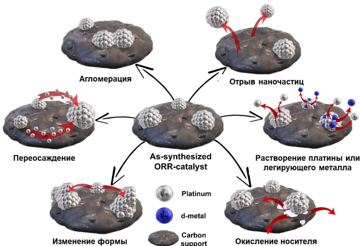
Рисунок 1.8 – Схематическое представление механизмов деградации частиц платины на углеродном носителе в топливных элементах [191]
