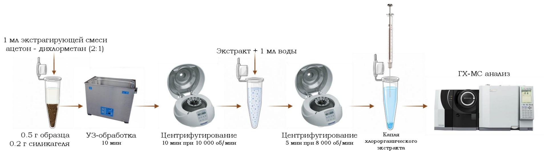
Рисунок 14 – Схема ГХ-МС-определения ПАУ в высокогумусной почве с пробоподготовкой, сочетающей техники QuEChERS и ДЖЖМЭ
