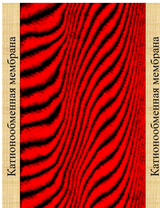
Рисунок 1.7 – Визуализация концентрационных профилей методом лазерной интерферометрии. Адаптировано из [24]
