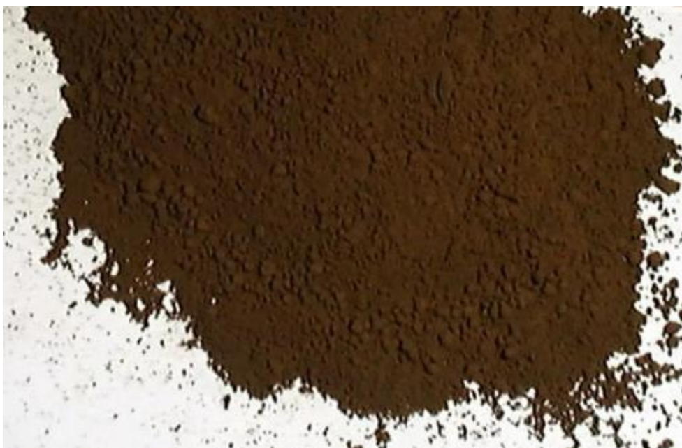
Рисунок 1 – Фотография пылевыхбросов газоочистки электросталеплавильного цеха АЭМЗ
