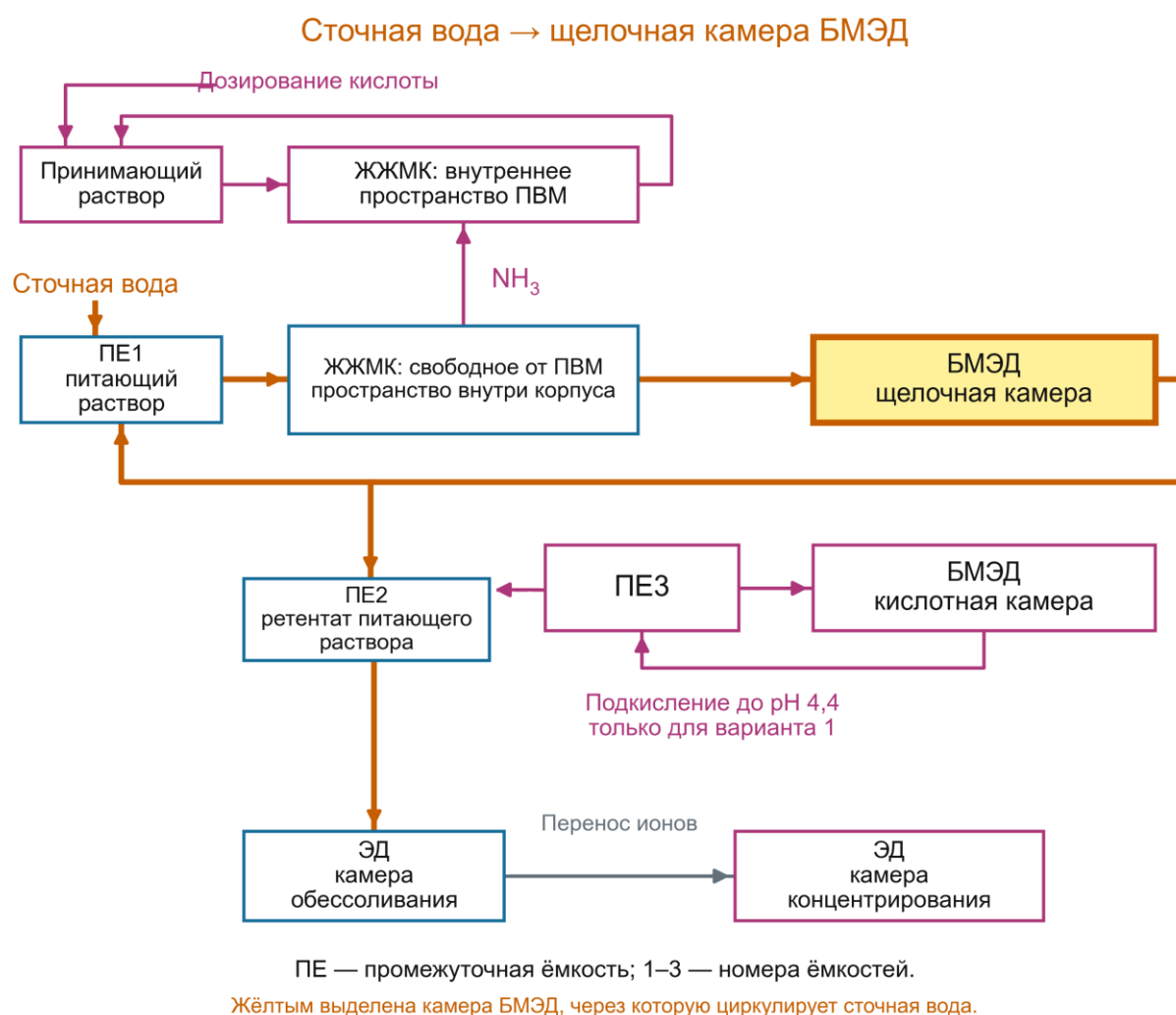
Рисунок 61 – Предлагаемый комбинированный процесс извлечения аммиачного азота и фосфатов из сточных вод азотно-фосфорных удобрений с циркулированием сточных вод через питающий контур ЖЖМК, сопряженный с щелочной камерой БМЭД
