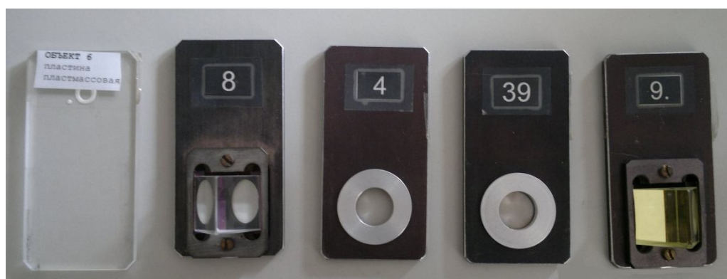
Рис.9.7. Набор объектов вставляемых в кронштейны поворотного столика интерферометра.
