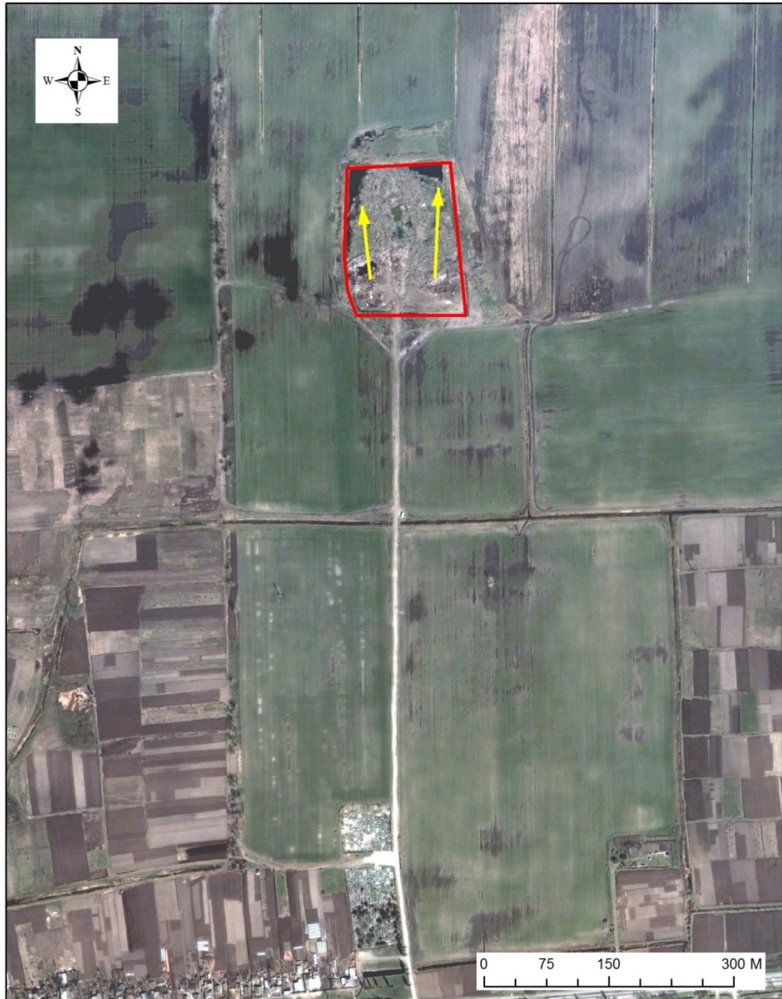
Рис. 6.4. Образование фильтрационными стоками поверхностных водоёмов. Свалка Коржевского сельского поселения, Славянский район. Стрелками показано направление фильтрационных стоков
