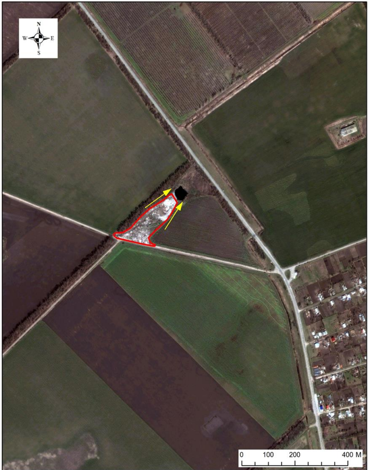
Рис. 6.3. Образование фильтрационными стоками поверхностного водоёма. Свалка Нововеличковского сельского поселения, Динской район. Стрелками показано направление фильтрационных стоков
