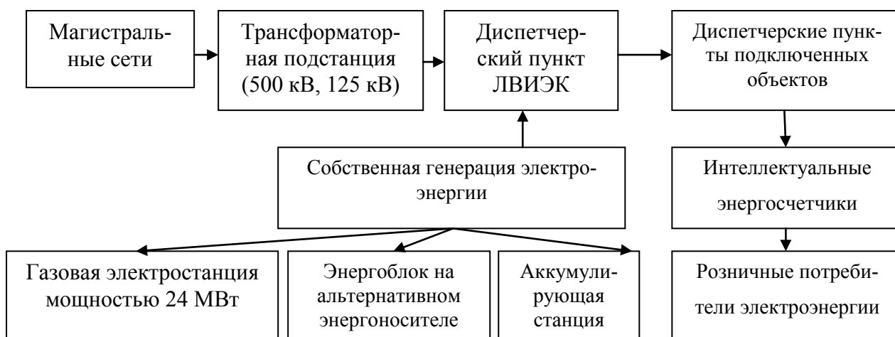
Рисунок 9 – Принципиальная схема ЛВИЭК на базе комбинированной генерации с использованием традиционного и альтернативного энергоносителя и подключением к магистральным сетям
