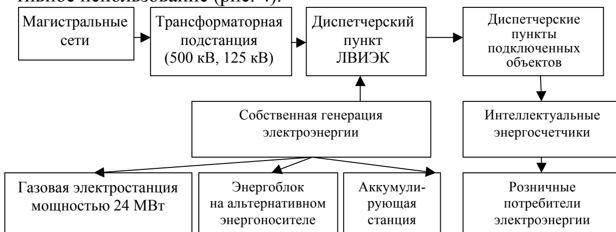
Рис. 4. Принципиальная схема ЛВИЭК на базе комбинированной генерации с использованием традиционного и альтернативного энергоносителя и подключением к магистральным сетям (авторская разработка)
