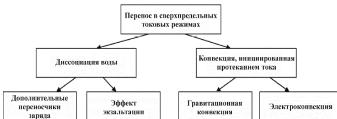
Рисунок 1.11 – Схема механизмов переноса в сверхпредельных токовых режимах [59]
