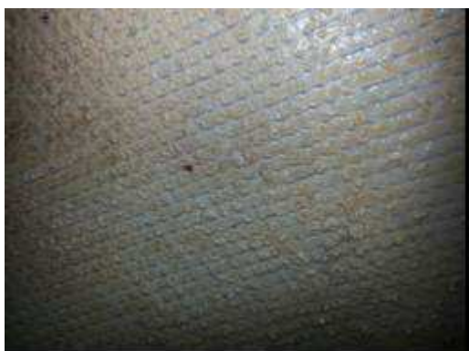
Рисунок 61 – Поверхность анионообменной мембраны, покрытая слоем осадка (слева); сухой осадок (справа)
