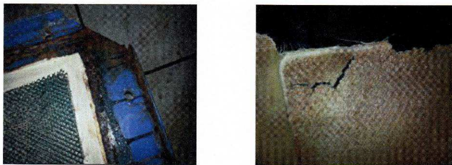
Рисунок 2 – Прижимная плита (слева); частично разрушенная анионообменная мембрана (справа)
