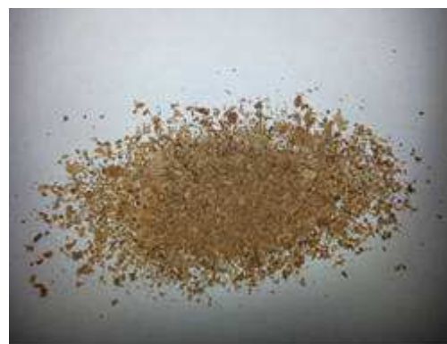
Рисунок 61 – Поверхность анионообменной мембраны, покрытая слоем осадка (слева); сухой осадок (справа)
