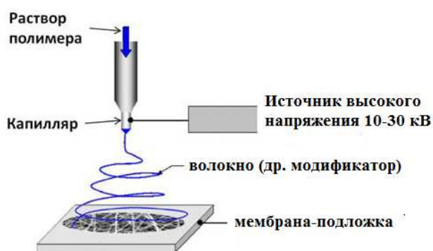
Рисунок 4 – Схема нанесения нановолокон (модификатора) на мембрану методом электроформования (адаптировано из [39])
