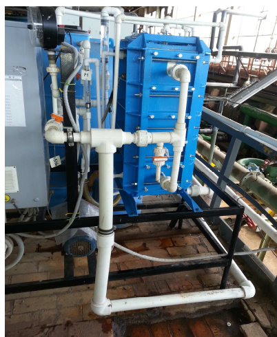
Рисунок 57 – Фото электродиализатора ЭДС-30-80 в составе гибридного бароэлектромембранного комплекса получения подпиточной воды для котельной
