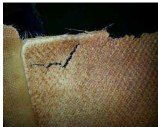
Рисунок 60 – Прижимная плита (слева); частично разрушенная анионообменная мембрана (справа)
