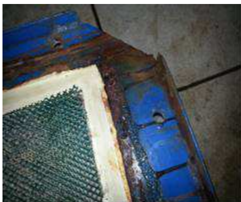
Рисунок 60 – Прижимная плита (слева); частично разрушенная анионообменная мембрана (справа)
