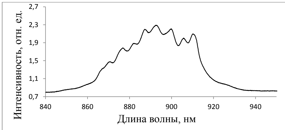
Рисунок 3.24 – Спектр люминесценции кристалла \text{SrWO}_4:\text{NdTaO}_4 ат. 2%, переход {}^4\text{F}_{3/2} \rightarrow {}^4\text{I}_{9/2} [77].
