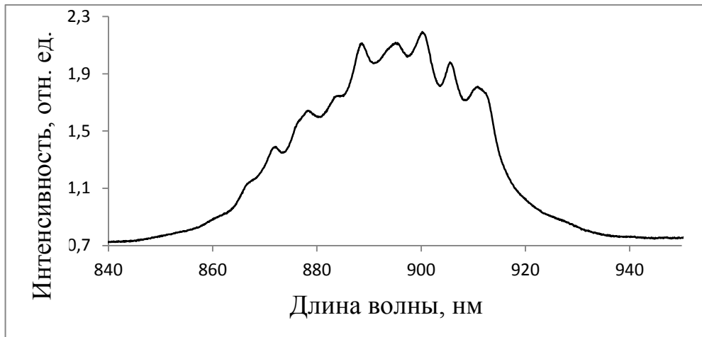
Рисунок 3.28 – Спектр люминесценции кристалла \text{SrMoO}_4:\text{NdNbO}_4 ат. 1%, переход {}^4\text{F}_{3/2} \rightarrow {}^4\text{I}_{9/2} [80].
