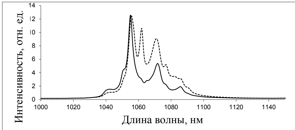
Рисунок 3.29 – Поляризованные спектры люминесценции \text{SrMoO}_4:\text{NdNbO}_4 ат. 1%, переход {}^4\text{F}_{3/2} \rightarrow {}^4\text{I}_{11/2} , сплошная линия – \sigma -поляризация, пунктирная – \pi -поляризация [80].
