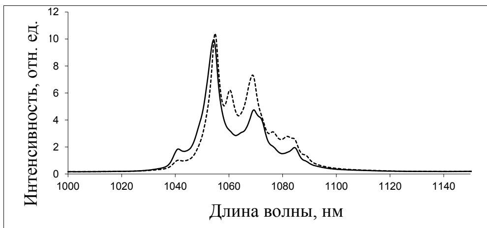
Рисунок 3.25 – Поляризованные спектры люминесценции кристалла \text{SrWO}_4:\text{NdTaO}_4 ат. 2%, переход {}^4\text{F}_{3/2} \rightarrow {}^4\text{I}_{11/2} , сплошная линия – \sigma -поляризация, пунктирная – \pi -поляризация [77].
