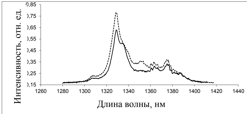
Рисунок 3.26 – Поляризованные спектры люминесценции кристалла \text{SrWO}_4:\text{NdTaO}_4 ат. 2%, переход {}^4\text{F}_{3/2} \rightarrow {}^4\text{I}_{13/2} , сплошная линия – \sigma -поляризация, пунктирная – \pi -поляризация [77].
