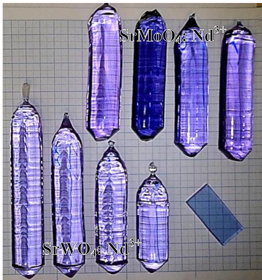
Рисунок 1.11 – Фотографии оптических монокристаллов SrWO 4 : Nd 3+ , SrMoO 4 : Nd 3+ , выращенных модифицированным методом Чохральского [56].
