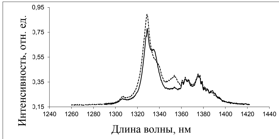
Рисунок 3.20 – Поляризованные спектры люминесценции кристалла \text{SrWO}_4 : \text{NdNbO}_4 ат. 1%, переход {}^4\text{F}_{3/2} \rightarrow {}^4\text{I}_{13/2} , сплошная линия – \sigma -поляризация, пунктирная – \pi -поляризация [77].
