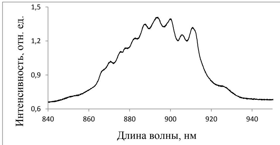
Рисунок 3.21 – Спектр люминесценции кристалла \text{SrWO}_4 : \text{NdNbO}_4 ат. 2%, переход {}^4\text{F}_{3/2} \rightarrow {}^4\text{I}_{9/2} [77].
