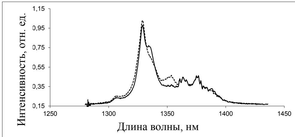
Рисунок 3.23 – Поляризованные спектры люминесценции кристалла \text{SrWO}_4:\text{NdNbO}_4 ат. 2%, переход {}^4\text{F}_{3/2} \rightarrow {}^4\text{I}_{13/2} , сплошная линия – \sigma -поляризация, пунктирная – \pi -поляризация [77].
