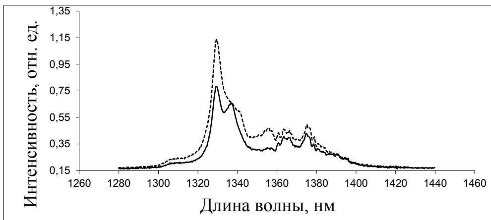
Рисунок 3.30 – Поляризованные спектры люминесценции \text{SrMoO}_4:\text{NdNbO}_4 ат. 1%, переход {}^4\text{F}_{3/2} \rightarrow {}^4\text{I}_{13/2} , сплошная линия – \sigma -поляризация, пунктирная – \pi -поляризация [80].
