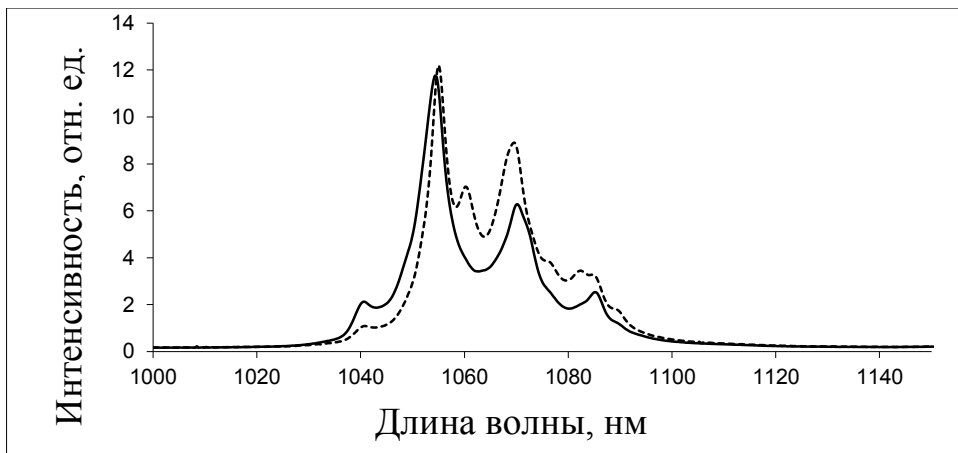
Рисунок 3.22 – Поляризованные спектры люминесценции кристалла \text{SrWO}_4 : \text{NdNbO}_4 ат. 2%, переход {}^4\text{F}_{3/2} \rightarrow {}^4\text{I}_{11/2} , сплошная линия – \sigma -поляризация, пунктирная – \pi -поляризация [77].
