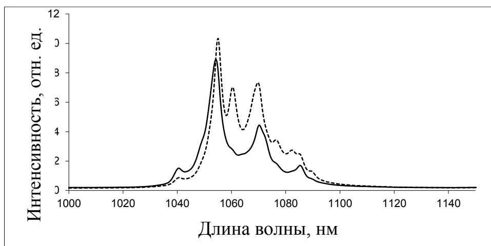
Рисунок 3.19 – Поляризованные спектры люминесценции кристалла \text{SrWO}_4:\text{NdNbO}_4 ат. 1%, переход {}^4F_{3/2} \rightarrow {}^4I_{11/2} , сплошная линия – \sigma -поляризация, пунктирная – \pi -поляризация [77].
