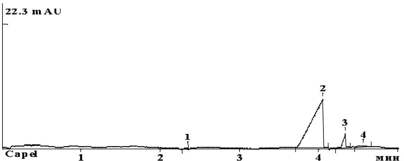
Рисунок 11 – Электрофореграмма стандартного раствора аммония, электролит № 8 из таблицы 20, положительное напряжение 14 кВ, пик 2 – аммоний
