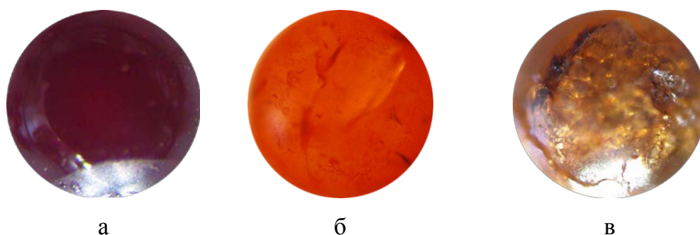
Рисунок 4.3 – Оптические изображения гранул катионита КУ-2 (а) и анионитов АВ-17-8 (б), АВ-17-2 (в) после длительного (более 800 часов) контакта с красным вином
