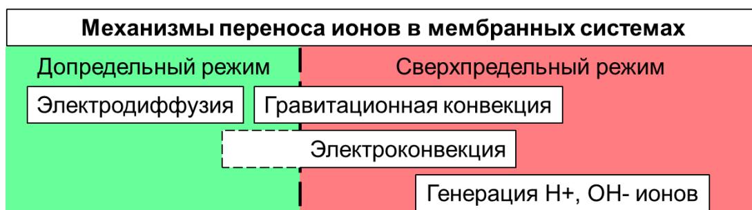
Рисунок 3 – Механизмы переноса ионов в мембранных системах
