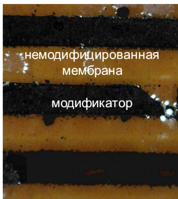
Рисунок 24 – оптическая фотомикрография поверхности модифицированной мембраны AMX-Sb 1:1
