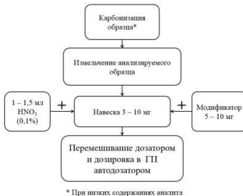
Рисунок 46 – Схема ЭТААС определения As, Cd и Pb в реальных образцах окружающей среды с применением техники дозирования суспензий с химическими модификаторами в графитовую печь
