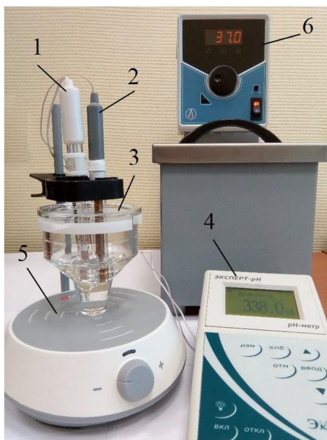
Рисунок 2.1 - Схема установки для проведения потенциометрических измерений в условия термостатирования. (1 – Хлорид-серебряный электрод, 2 – Платиновый электрод, 3 – Термостатируемая электрохимическая ячейка, 4 – pH-метр «Эксперт-pH», 5 – Магнитная мешалка, 6 – Термостат)
