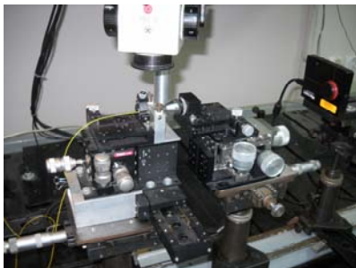
Рисунок 14 – Фотография базовой части станда для проведения измерений интегрально-оптических элементов и схем
