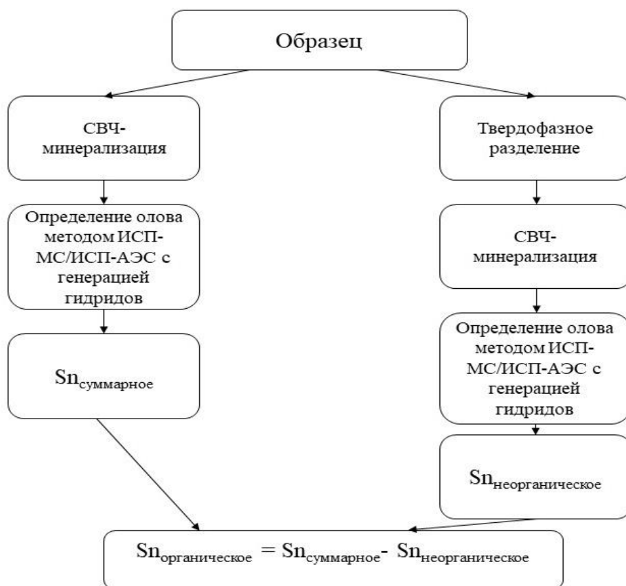
Рисунок 14 – Схема определения различных химических форм олова методами ИСП-спектрометрии
