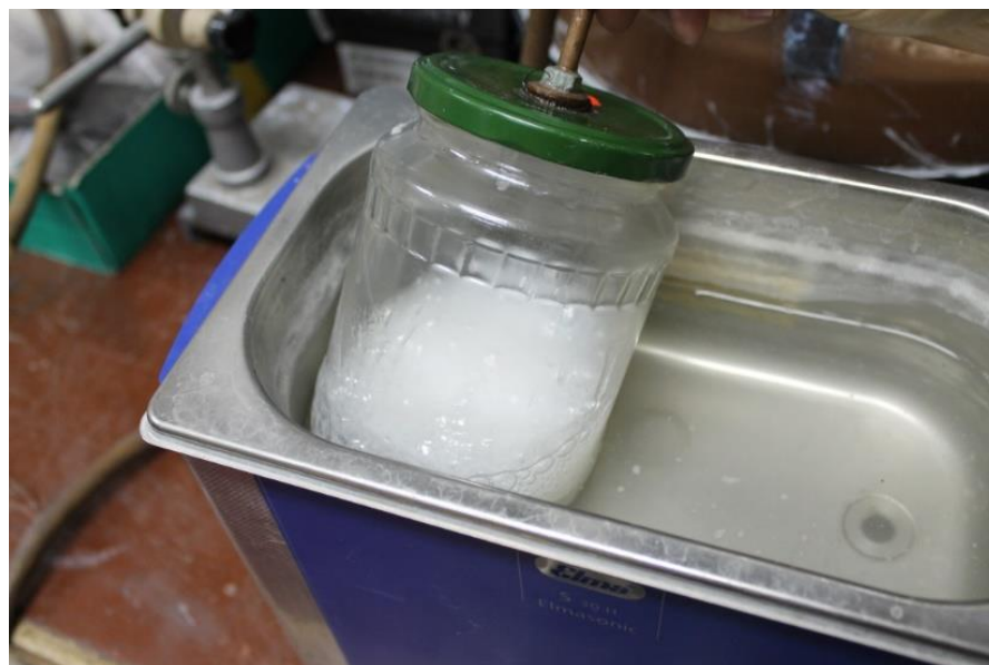
Рисунок 2.10 – Активный выход пузырей воздуха в процессе вакуумной дегазации эпоксидной смолы ЭД-20 содержащей наночастицы Ts150
