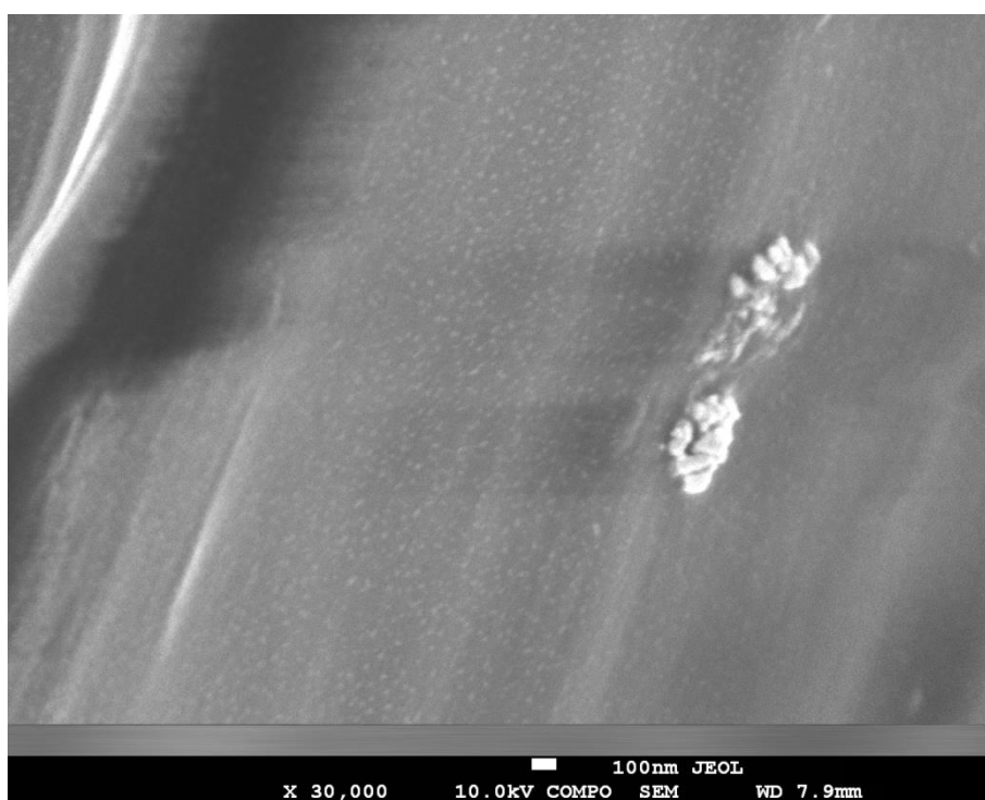
Рисунок 4.5 – Электронная микрофотография наночастиц серебра на поверхности волокон шелка в составе альгинатно-тканевого покрытия в режиме СОМРО с увеличением в 30 000 раз после выполнения 10-кратной циклической заморозки.
