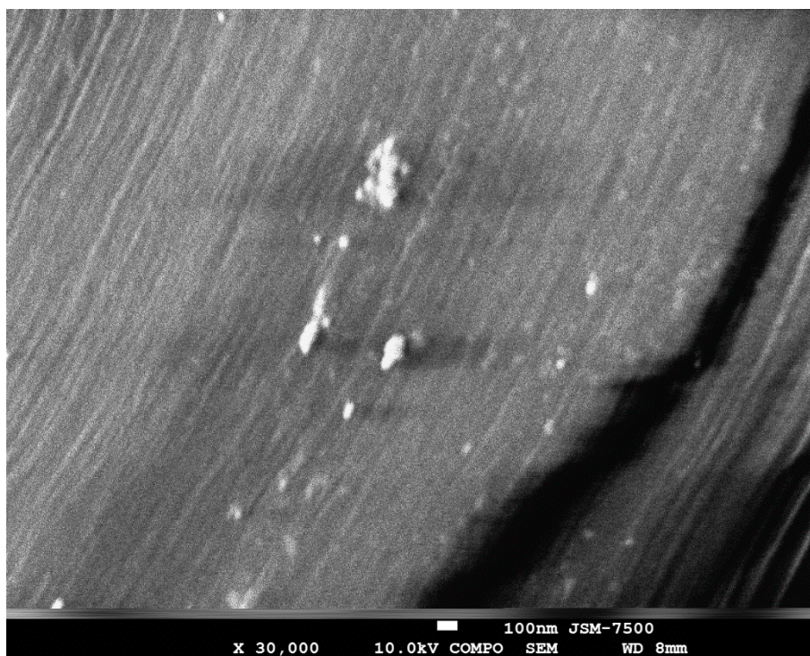
Рисунок 4.4 – Электронная микрофотография наночастиц серебра на поверхности волокон шелка в режиме СОМРО с увеличением в 30 000 раз до выполнения циклической заморозки
