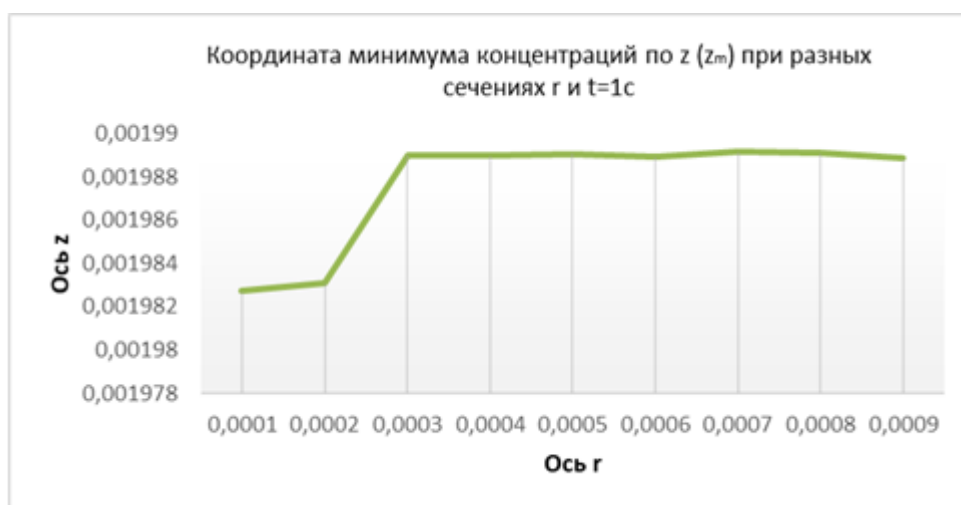
Рисунок 3.5 – Значения толщины квазиравновесной ОПЗ в зависимости от сечений по r
