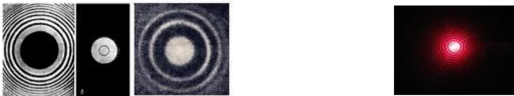
Рис. 1.9. Наличие пятна Пуассона в центре тени диска произвольного диаметра при условии достаточной когерентности освещающей волны
