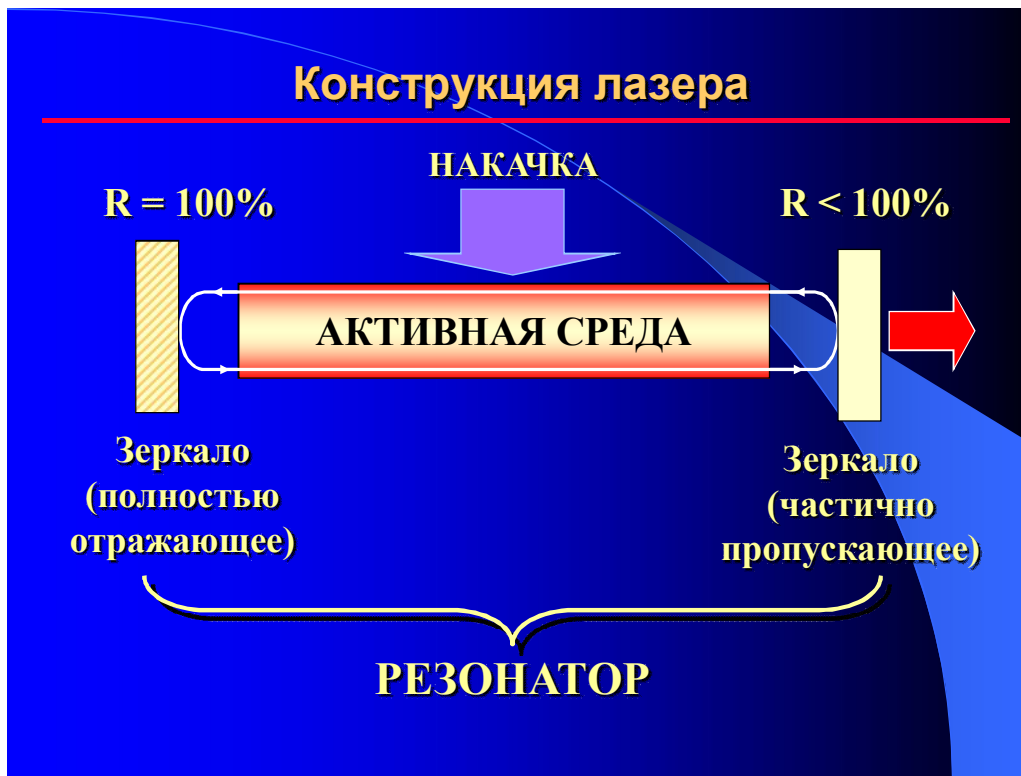
Рис. 1.3. Схема устройства лазера
