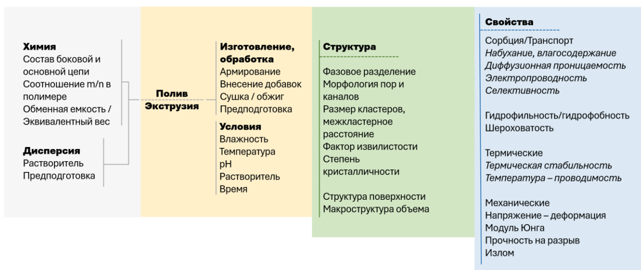
Рисунок 1.4 – Связь «способ изготовления – состав – структура – свойства» перфторированных ионообменных мембран. На основе схемы Kusoglu A. и соавт. [9]
