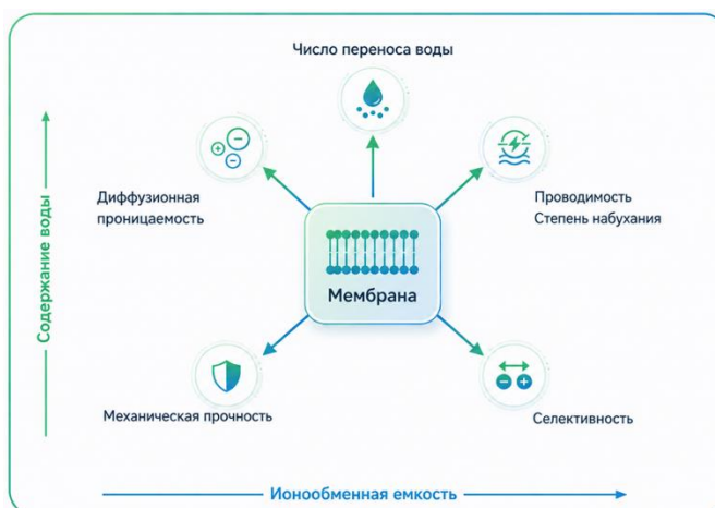
Рисунок 1.7 – Схематическое представление взаимосвязи характеристик ионообменной мембраны. Стрелками обозначено направление увеличения соответствующего параметра. Адаптировано из [84]
