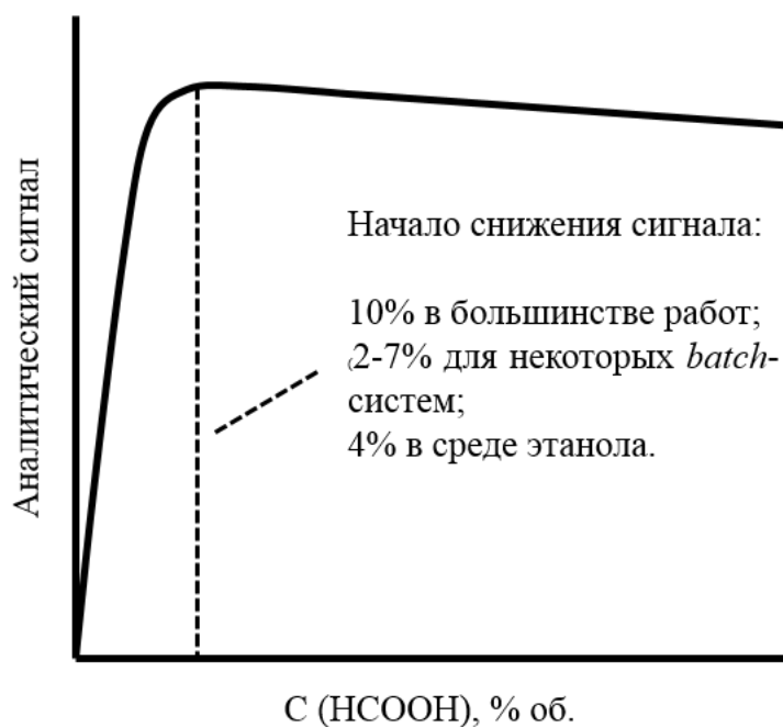
Рисунок 7 – Типичный вид зависимости АС ртути от концентрации муравьиной кислоты согласно литературным данным
